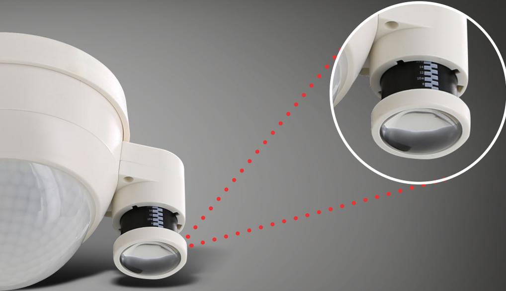
El sensor de luz telescópico se sitúa en la posición de la escala correspondiente a la altura de montaje, con ello se evitan en gran medida las incidencias molestas de luz en los laterales de las estanterías. Así, es posible una regulación más exacta en función del aporte de luz natural y la altura de montaje (hasta 16 m).
