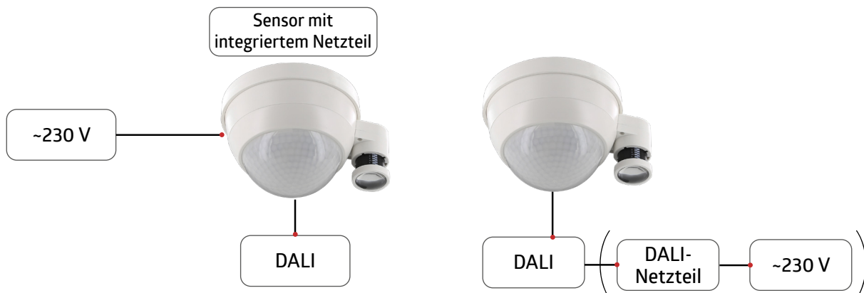
Abb. 4: Positionierung DALI-Netzteil, links: 230 V-Anschluss, rechts: DALI-Bus-betrieben
