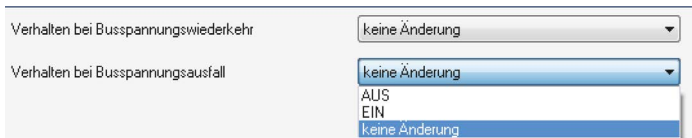
Abbildung 9: Verhalten bei Busspannungsausfall/-wiederkehr
